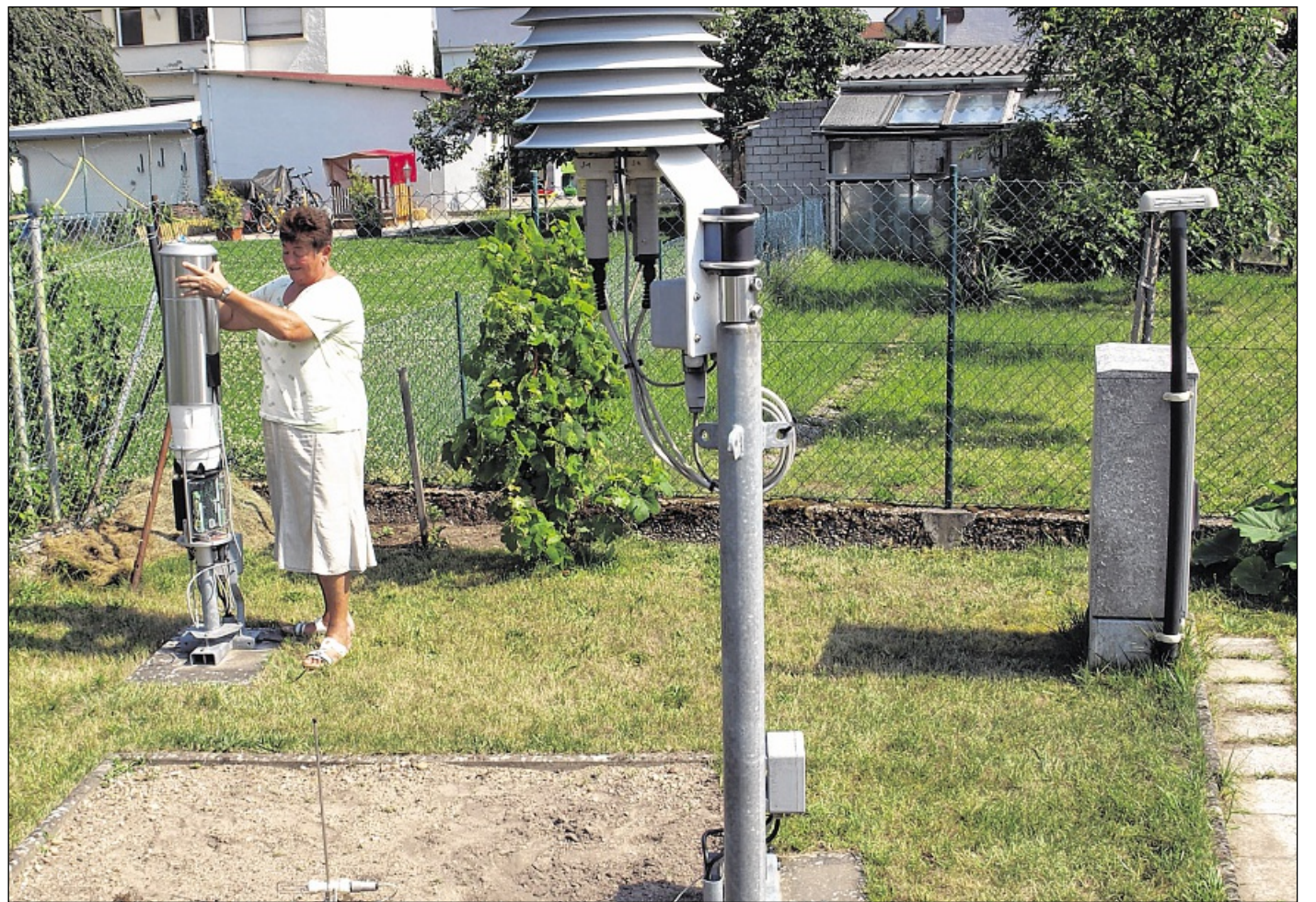
SEIT 30 JAHREN WETTERFROSCH: Im Garten von Ingeborg Herber unterhält der Deutsche Wetterdienst eine Messstation. Der zwei Meter hohe Temperaturmesser (vorne) ist dieses Wochenende möglicherweise für einen Rekord gut. Fotos: Schmidhuber, pr
